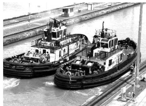
Kanał Panamski - holowniki wprowadzające i zastępujące je podczas przejścia lokomotywy elektryczne
