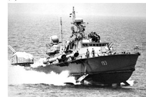
kuter torpedowy wyposażony w płyty nośne jak wodolot, dzięki którym może w chwili ataku osiągać większe prędkości;
