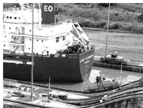
Kanał Panamski - holowniki wprowadzające i zastępujące je podczas przejścia lokomotywy elektryczne
